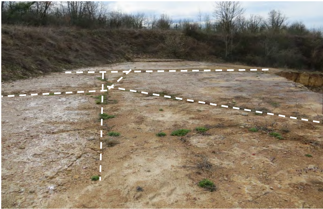
Exemple de faisceaux de discontinuités qui "prédécoupent" le gisement de la carrière.
